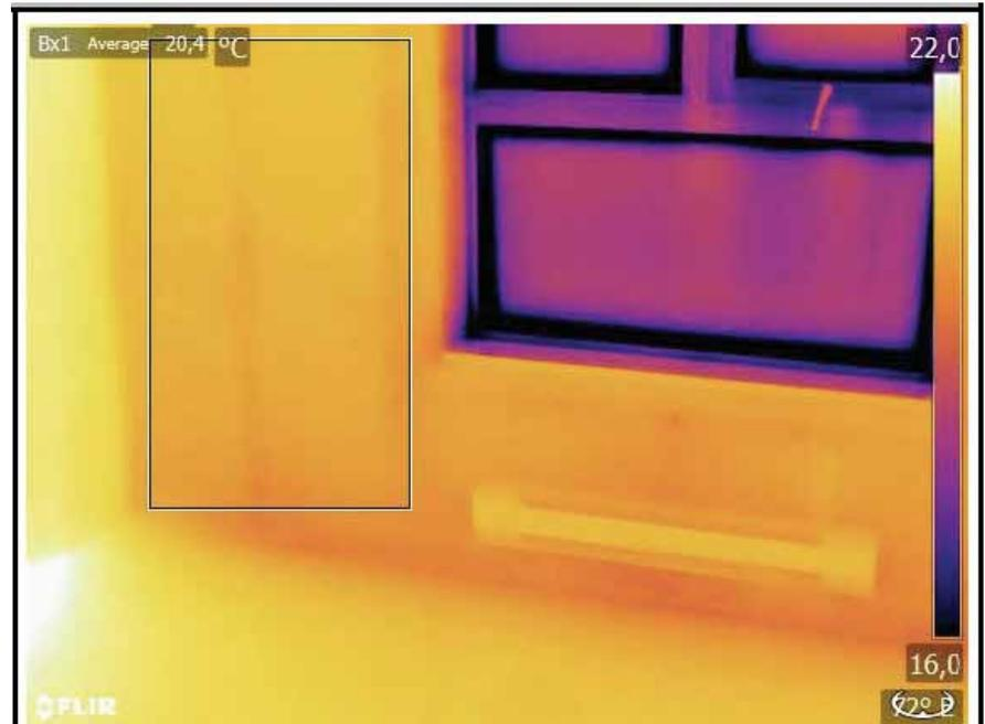
**Thermogramme n° 14:** (Unité 314 en conditions usuelles) Bon comportement thermique du mur avec des attaches en fibre de verre. Dans la partie courante du mur, la température de surface moyenne est d'environ 20,4 °C.
